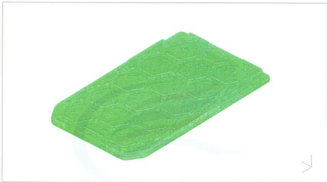
กำหนดจุดรองรับบริเวณตำแหน่งที่ติดกับแป้นยึดของล้อทั้ง 4 ของรถเข็น
